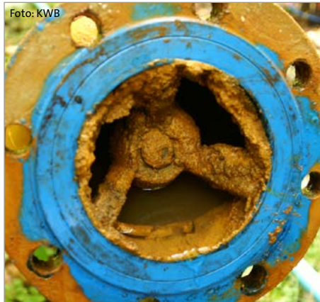
Eisenablagerungen am Druckstutzen einer Unterwassermotorpumpe aus einem Trinkwasserförderbrunnen
