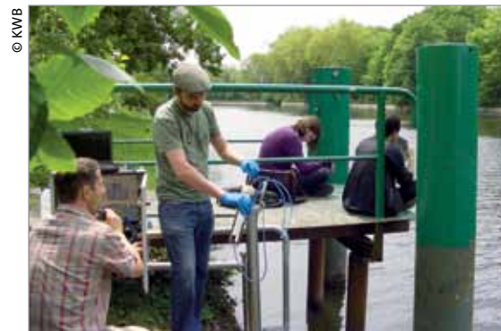
Wartung von Messsonden an der Berliner Stadtspreewasser
