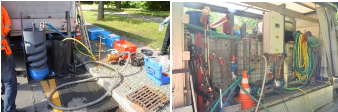
Abbildung 4.12: BUDAVINCI Typ-N, Reinigungsanlage mit Wasserrückgewinnung auf einen LKW montiert, externer Dienstleister
