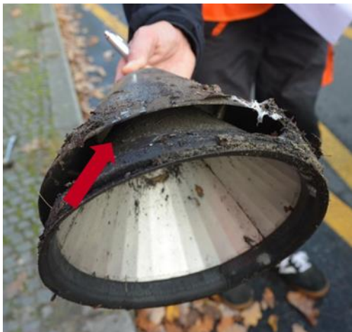
Abbildung 4.9: Doppelkegelkappe als Überlauf für INNOLET-G
