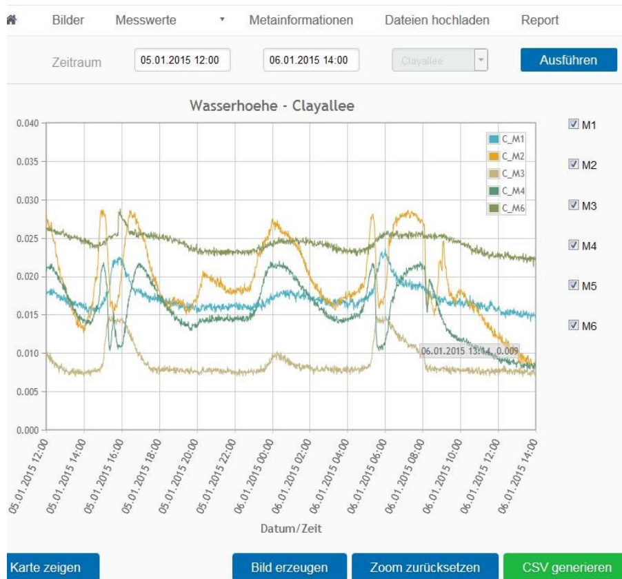
Abbildung 3.21: Graphische Darstellung gemessener Zeitreihen im Webbrowser. Hier: Wasserstände (in cm) in den Messschächten der Clayallee
