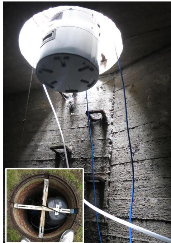
**Abbildung 8:** Typische Installation von Sensoren und in den Schacht gehängtem Probenehmer
