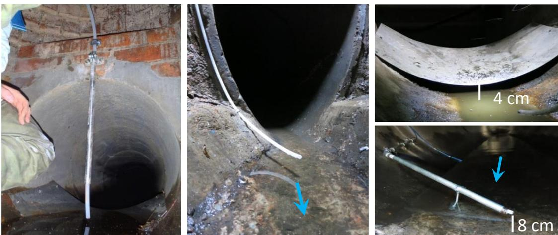
**Abbildung 44:** links: mittige Befestigung des Probenahmeschlauches von oben im Kanal; Mitte: seitliche Befestigung des Probenahmeschlauches; rechts: Abstand zwischen Anstauschwelle/ Probenahmeschlauch und Kanalsole
