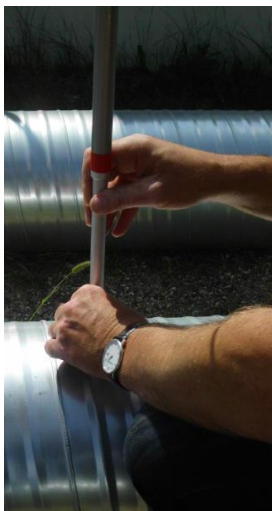
Abbildung 4: Messung mittels Flügelradmesser im Rohgas zur Mitbehandlung
