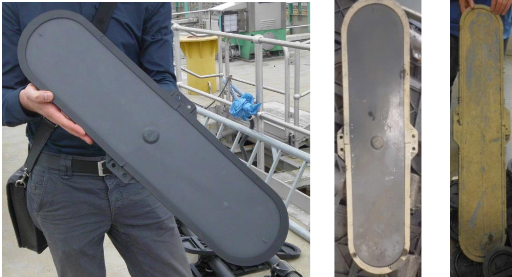
Abbildung 28: links: neue Silikonmembran; Mitte: Silikonmembran nach Ausbau; rechts: TPU-Membran nach Ausbau
