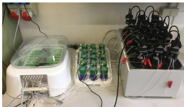
Abbildung 4: Aufbau zur Messung des Biomethanpotentials (Gerät: AMPTS® II, BPC Instruments)
