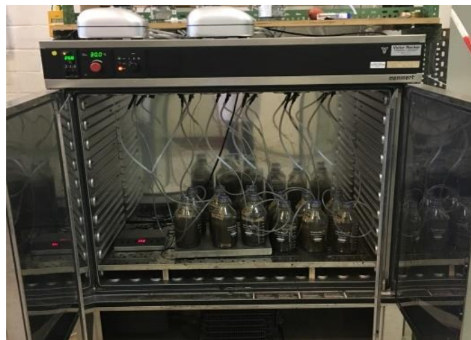
Abbildung 5: Aufbau zur Messung der aeroben biologischen Abbaubarkeit (Zahn-Wellens-Test)
