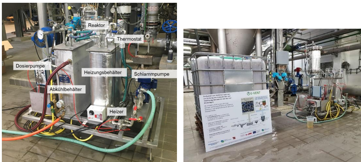
Abbildung 7: Pilotanlage zur thermo-alkalischen Hydrolyse der Firma Pondus (links), Aufstellung im Klärwerk Waßmannsdorf (rechts)
