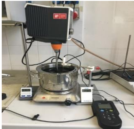
Abbildung 3: Laboraufbau zur thermo-alkalischen Hydrolyse
