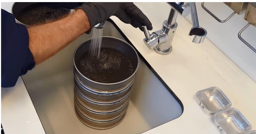
Abbildung 47: Siebturm zur Bestimmung der Korngrößenverteilung (Quelle: Schulungsvideo RHDHV)
