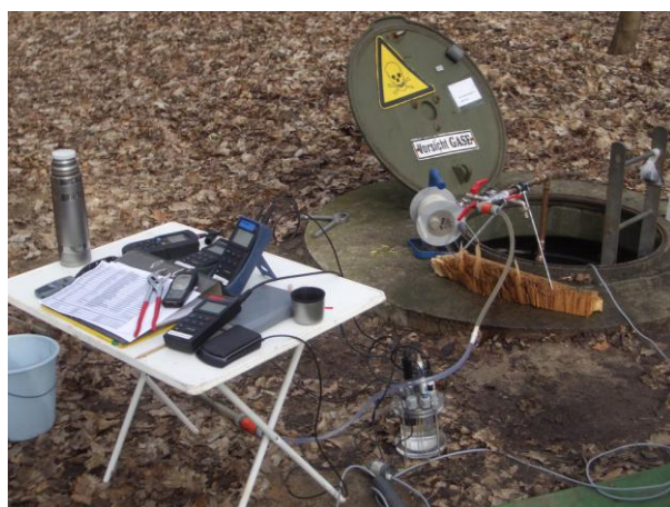
Fig. 3: Appareils d'échantillonnage pour l'analyse à courte durée de prélèvements d'eau microbiologiques et hydrochimiques. Dispositif de mesure avec cellule d'écoulement pour les paramètres hydrochimiques de champ [FUB 2009]
